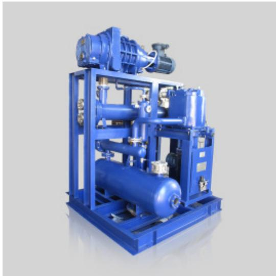
为了使罗茨泵在较高的压差下工作，以扩大使用范围，增加泵的可靠性，就必须设法散出转子产生的热量，也就是说要对转子进行冷却。为了理解空气冷却的实质，先来看一下气体在罗茨真空泵排气一侧的流动情况，在罗茨真空泵中吸入气体被压缩的过程不是连续的，而是突然的。吸入气体随转子转动而被封闭于腔内，又随转子的旋转，使腔内的气体突然与排气口接通。由于排气一侧的气体压力较高，排气口处的气体就向腔中返冲，然后又随着转子的旋转而被驱赶排出泵外。这样的过程在每旋转一周中两个转子共进行四次排气过程。从上述气体的流动情况可以设想：假若每次返冲到泵腔中的气体是冷的，则可以在高温的泵腔内吸收大量的热量，这些吸收了热量的气体又在转子的继续压缩中排出，从而会达到转子冷却的目的。空气冷却就是运用上述原理。在泵的排气口处设置密集的冷却片，冷却片用冷水管进行冷却，或在泵的排气口处直接安装冷却水管，这样排气口处的气体就会降温，这种冷却方法能有效地散出罗茨泵转子在压缩气体中所产生的热量。而且当排气压力较高时，因气体分子的密度大，使热传导性能更好，其冷却效果也好些。使用这种方法能保证泵在较高的压差下工作，实验证明。
