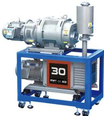
通过驱动罗茨真空泵的质量功率进一步提高了人体产生强度的性能，提高罗茨真空泵的质量性能，多面加速了整体的应用强度，通过应用强度的驱动，提高了其质量性能的提升。罗茨真空泵机组开工前的准备工作：下面由罗茨真空泵厂家来介绍罗茨真空泵开机前的准备工作是怎样的，罗茨真空泵机组一般是以罗茨泵为主泵，水环泵为前级泵组成的，这一真空机组广泛应用于各个工业当中，比如说食品工业的冻干工艺、医药工业的干燥工艺、化工业的真空蒸馏、结晶工艺等等。为了帮助各位客户更好的使用好我们的产品，我们在这里介绍一下罗茨真空机组开车前的准备工作：1. 检查前级泵水箱液位是否达到水箱的3/4以上，若不足则补足。2. 检查水箱内所使用的水是否清洁，不允许用含有泥沙的污水，以免堵塞管路，造成叶轮磨损、增大电机负荷造成故障，影响泵的使用寿命。3. 检查中间泵及主泵泵体内的润滑油油面高度，必须达油窗的3/4以上，同时检查润滑油的颜色，罗茨真空泵出现乳白色或黑色杂质较多则通知机修更换润滑油。4. 检查中间泵及主泵循环冷却水水路是否完好，打开循环冷却水进出口阀门，检查循环冷却进出水是否正常。5. 检查中间泵底部缓冲罐排污阀门是否
